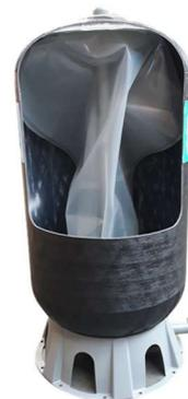
La vessie, innovante, a spécialement été conçue pour les réservoirs Compose It™, afin de garantir leur longue durée de vie. Le polyuréthane a été sélectionné et formulé pour assurer à la vessie, d'excellentes propriétés mécaniques, une forte résistance à l'abrasion et une étanchéité maximale. **Le volume de la vessie, supérieur à celui du réservoir** permet de réduire au minimum les contraintes mécaniques sur la vessie pendant l'utilisation du réservoir.
